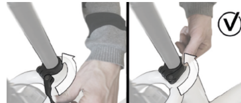
Abb. 8: Schließen des Schnellspanners der Sattelstütze
