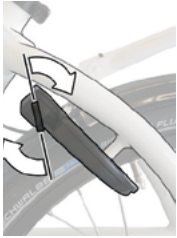
Abb. 29: Drehen Sie den Schlüssel um 20 bis 30 Grad im Uhrzeigersinn
