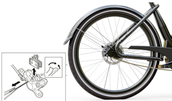
Abb. 42: Demontage der Bremsbeläge zur Überprüfung der Abnutzung
