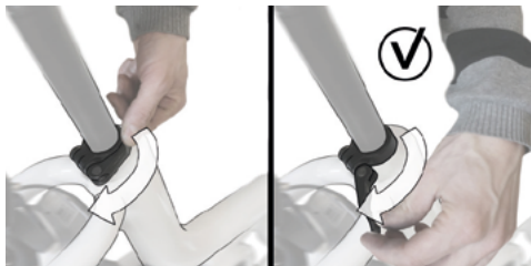
Abb. 6: Öffnen des Schnellspanners der Sattelstütze
