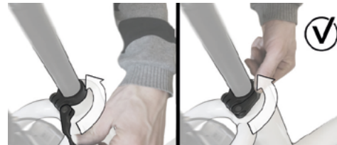
Abb. 8: Schließen des Schnellspanners der Sattelstütze
